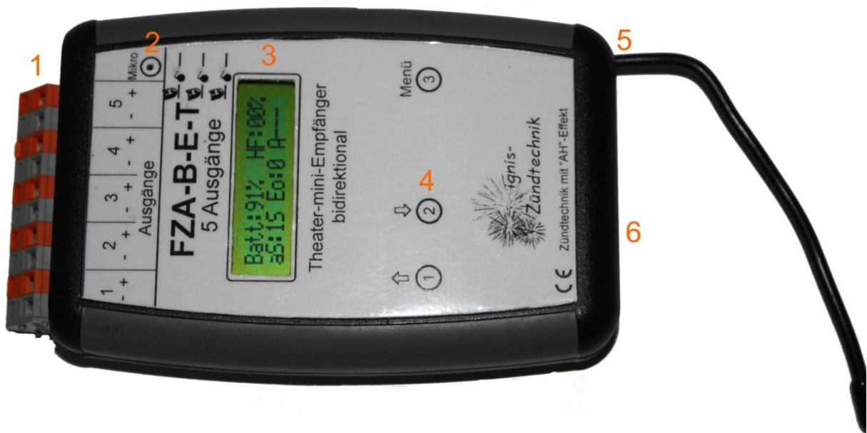
Abb. 4.1: Ansicht des bidirektionalen Theater-mini-Empfängers (FZA-B-E-T). Geräte der neuen Generation haben ein größeres 3-zeiliges Display und können mittels des Magnetstiftes ein- und ausgeschaltet werden (Abbildung folgt).
