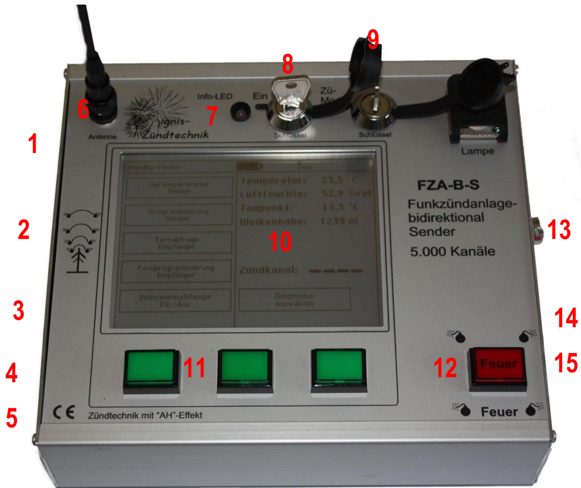
Abb. 2.1: Ansicht des Senders und Funktion der Bedienelemente
